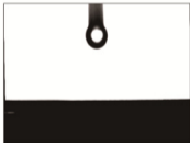
图 2 纯水 SLA 处理钛合金表面接触角测量照片
